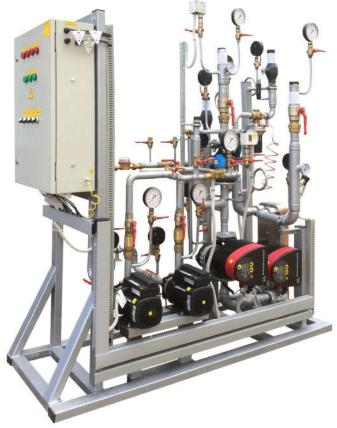
БТП предназначены для приема, распределения и автоматического учета тепловой энергии, автоматического регулирования параметров теплоносителя (горячей воды) с рабочим давлением до 1,6 МПа и температурой не более 150 °C, в границах от запорной арматуры тепловой сети и хозяйственно-питьевого водопровода на вводе в пункт, до запорной арматуры местных систем отопления, горячего водоснабжения и теплоснабжения установок систем вентиляции и кондиционирования воздуха.
